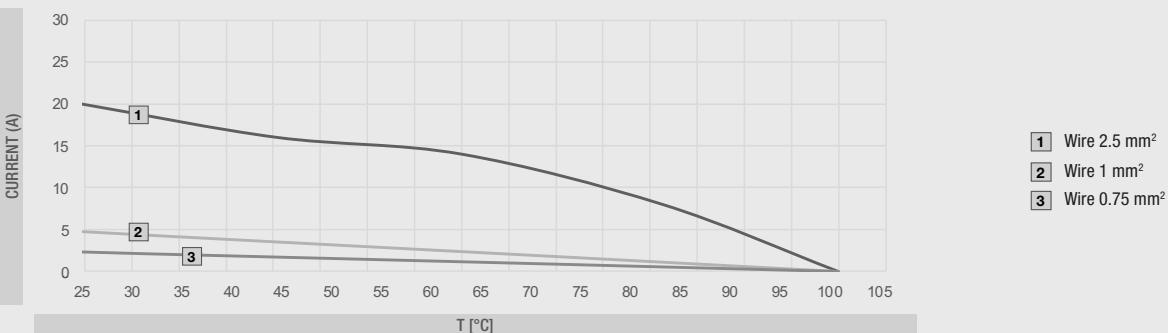
**N.B.:** per la gamma TH387U si riportano due grafici riferiti alla curva di derating, in quanto la versione 3Poli supporta fino a 2.5mm<sup>2</sup>, mentre la versione 4Poli supporta la versione 1.5mm<sup>2</sup>.
